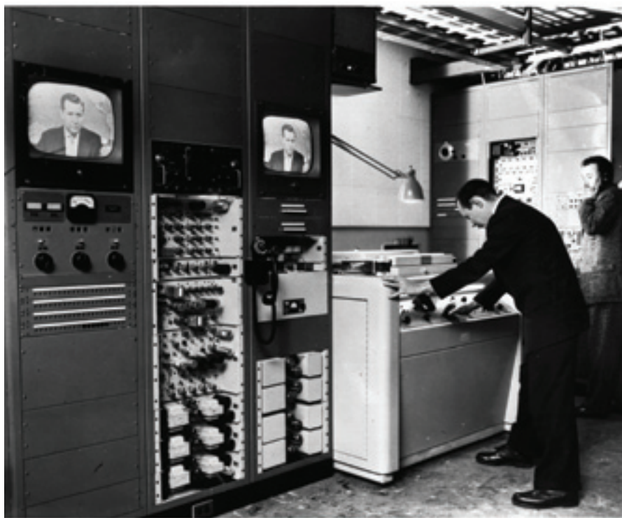
1956 г. Трансляция из аппаратной CBS при помощи видеомэгнитофонов AMPEX VRX-1000
